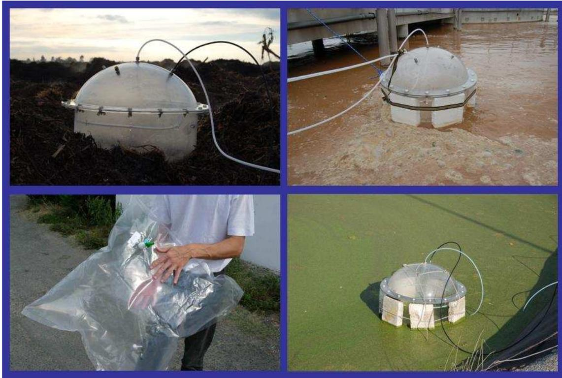
**Figure A-0 : vues de OdoFlux sur des surfaces solides et liquides et d'un sac d'échantillonnage en Tedlar.**
