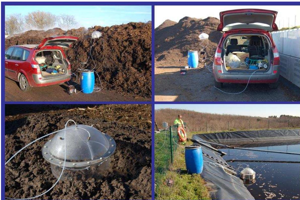
Figure 3: Illustrations des méthodes de prélèvement. Le caisson bleu est le caisson poumon mis en dépression par une pompe alimentée sous 12 volts. Pour les prélèvements en chambre de flux dynamique, une bouteille d'azote (dans le véhicule) permet de conserver une pression atmosphérique dans la chambre de façon à garantir un prélèvement le plus fidèle aux conditions normales d'évaporation. En haut, prélèvement sur andain, en bas la chambre de flux sur les boues et sur la lagune.
